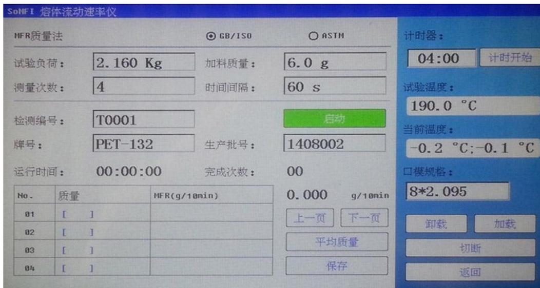
准备好试验配件如：漏斗、加料顶杆、清料杆、口模清洗棒、纱布、隔热帆布手套。当系统恒温 15min 后，即可进行试验。
