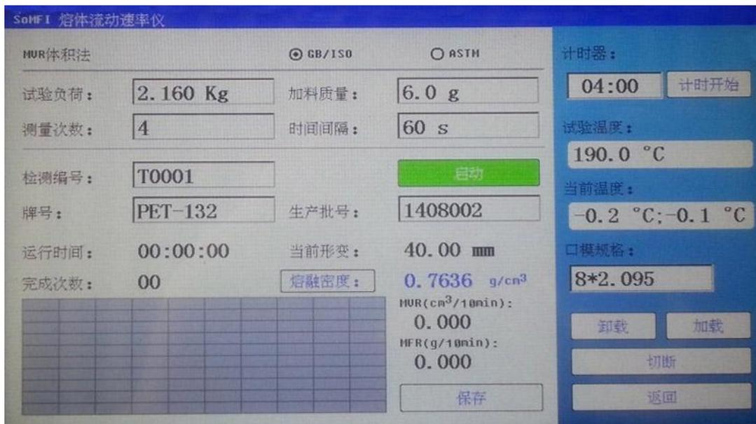
准备好试验配件如：漏斗、加料顶杆、清料杆、口模清洗棒、纱布、隔热帆布手套。当系统恒温 15min 后，即可进行试验。
