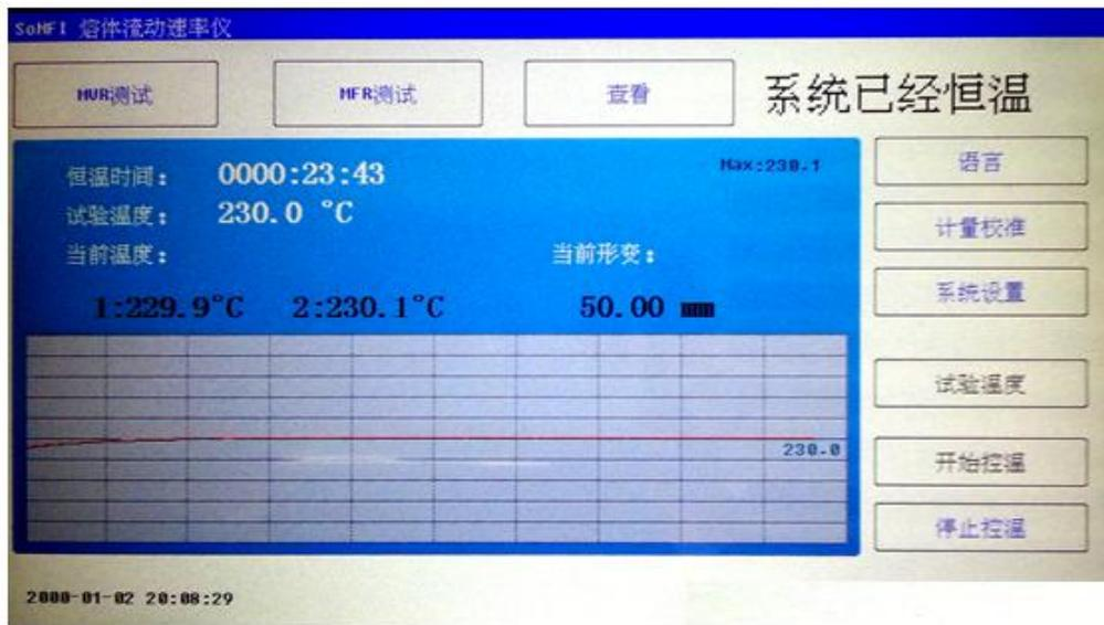
上图是恒温后的显示界面，试验温度为 230℃，在此界面下可以重新设定温度，进入系统设置界面、计量校准界面、试验记录界面以及 MVR/MFR 测试界面。
